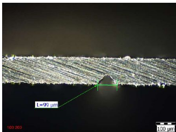
Obr. 2.28: Příčný výbrus laserové rýhy po chemickém leptání. Rychlost scanování laserového paprsku 200 \text{ mms}^{-1} .
