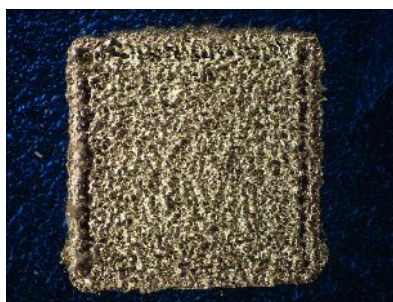
Obr. 4.15: Středová kontaktní ploška obrazce „Reimer“ bez žihání. Rozměry plošky 560x560 μm. Optický mikroskop.
