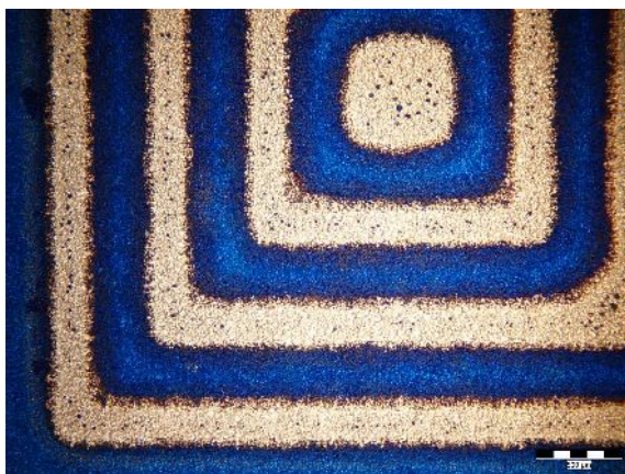
Obr. 2.30: Vyleptaný motiv „Reimer“ do nitridové masky. [7]
