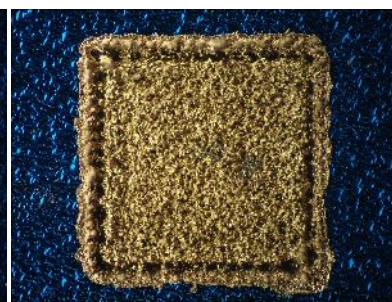
Obr. 4.17: Středová kontaktní ploška obrazce „Reimer“ po žihání při 300 °C po dobu 180 s v atmosféře N 2 . Optický mikroskop.
