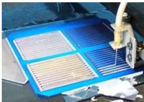
Obr. 2.3: Dispenzní tisk kovové tlustovrstvé pasty na strukturu článku se zanořenými zadními kontakty. [13]
