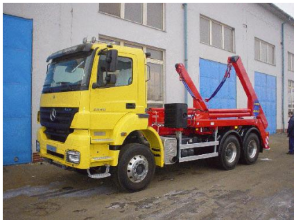
Obr. č. 18 Ramenný nosič kontejnerů (Katalog firmy HCS SK)
