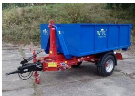
Obr. č. 11 Traktorový nosič kontejnerů PORTÝR (Katalog firmy WTC Písečná)
