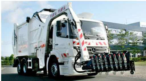
Obr. č. 16 Nákladní automobil s předním nakladačem nádob (Katalog firmy FAUN)
