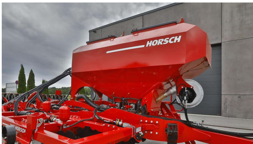
Obr. 15 Dvoukomorový zásobník pro Tigger MT [9]
