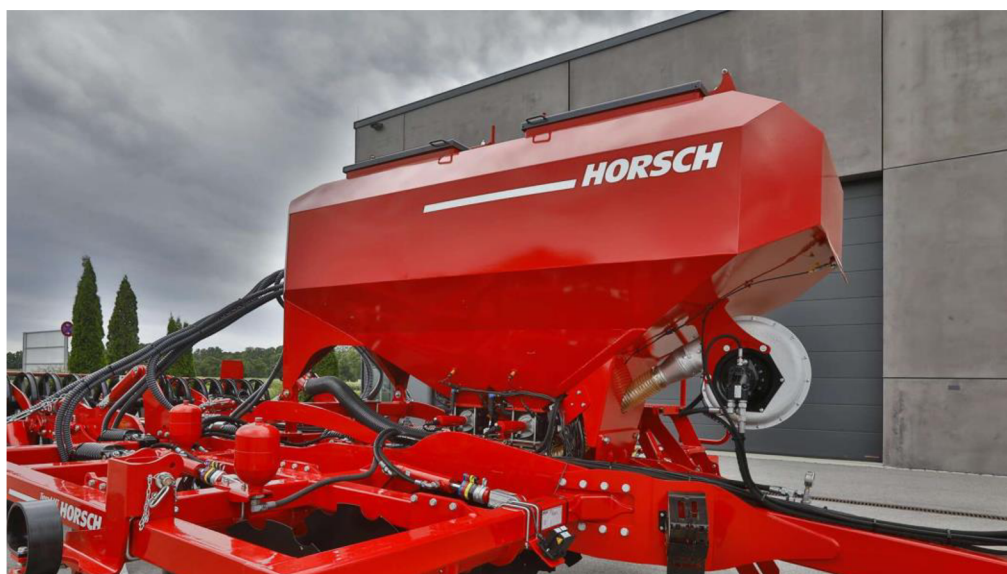
Obr. 15 Dvoukomorový zásobník pro Tigger MT [9]
