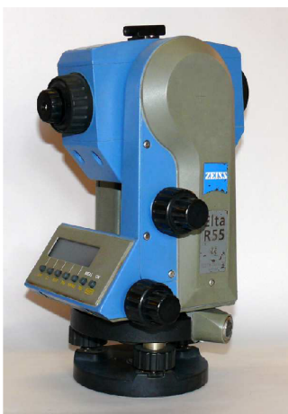
Obrázek 14 – foto - Totální stanice ZEISS ELTA R 55 [13]
