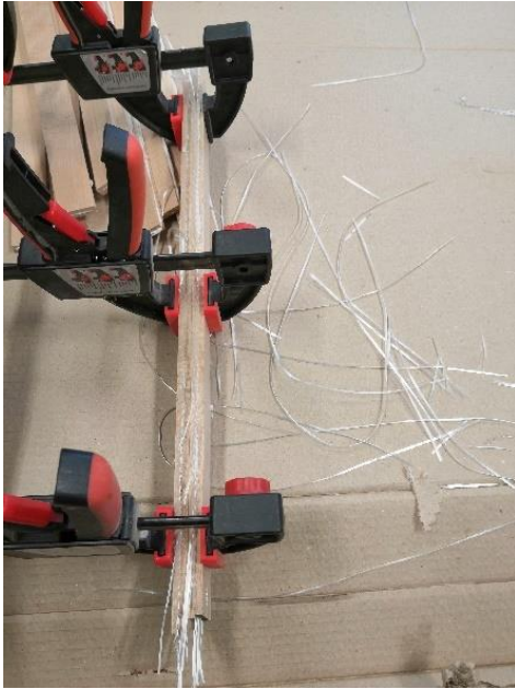
Obrázek 17 Lisování vzorků mechanickými svorkami
