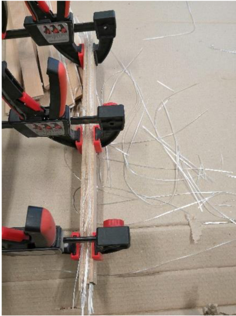
Obrázek 17 Lisování vzorků mechanickými svorkami
