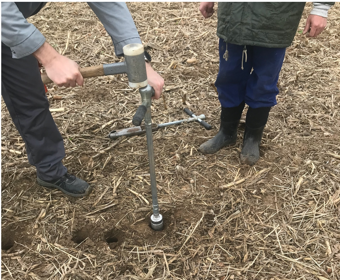
Obrázek 8: Odebírání vzorků do Kopeckého válečku pomocí násadce (foto autor)
