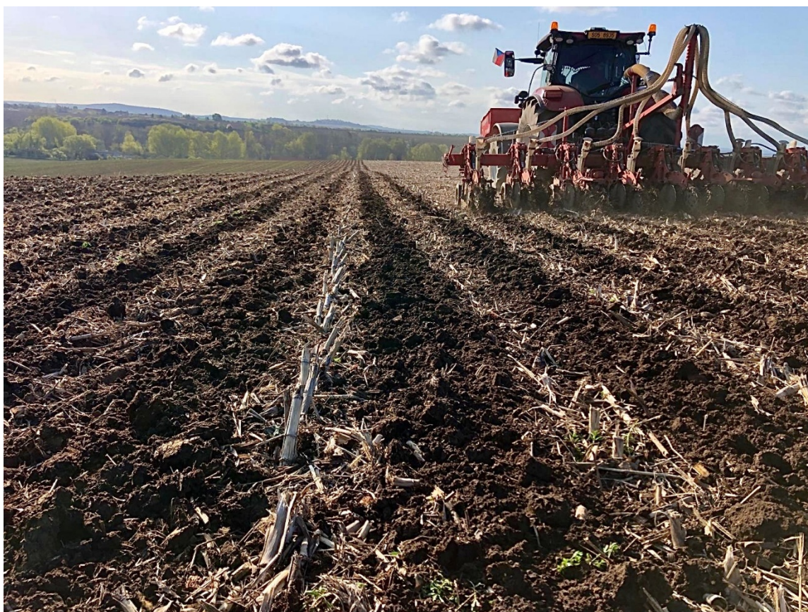
Obrázek 2: Souprava traktoru Case IH Puma a Kverneland kultistrip při pásovém kypření do mezířadí předplodiny (foto autor)
