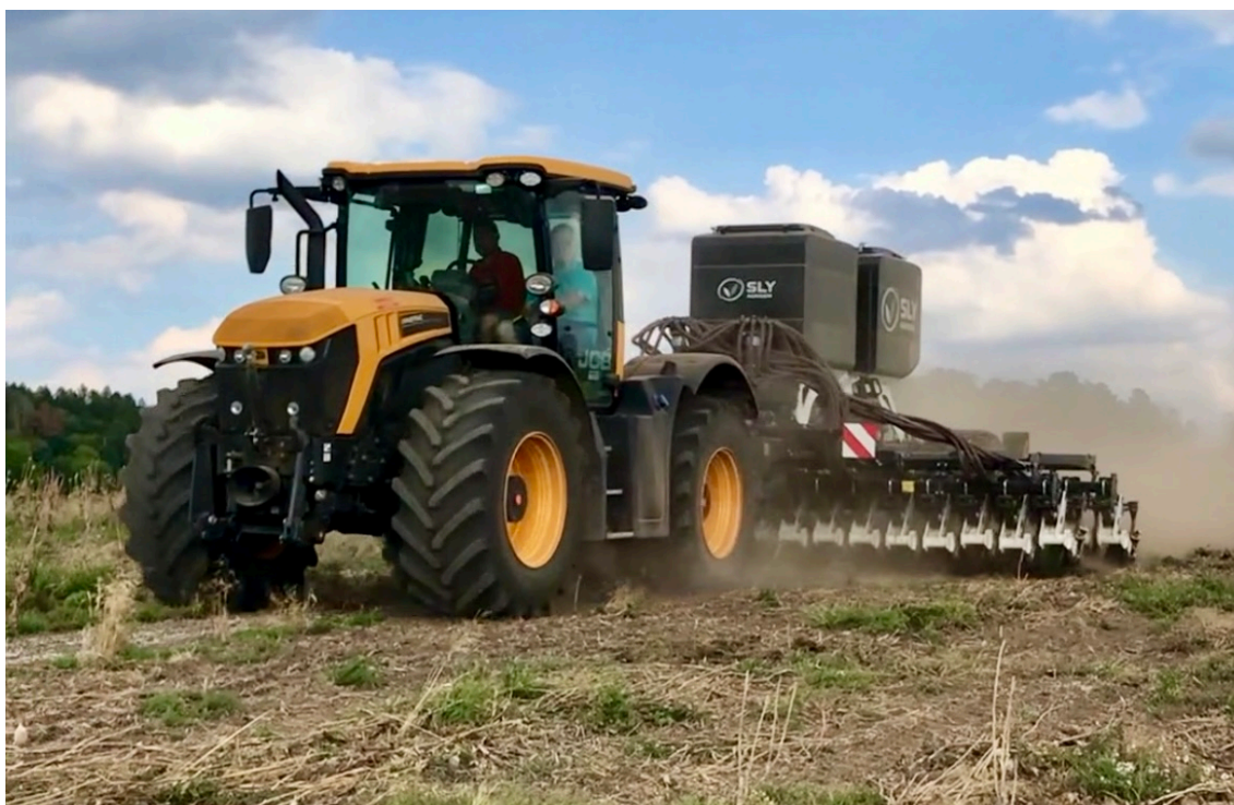
Obrázek 3: Operace přímého setí No-till secím strojem Sly Agrisem a traktor JCB Fastrac (foto autor)
