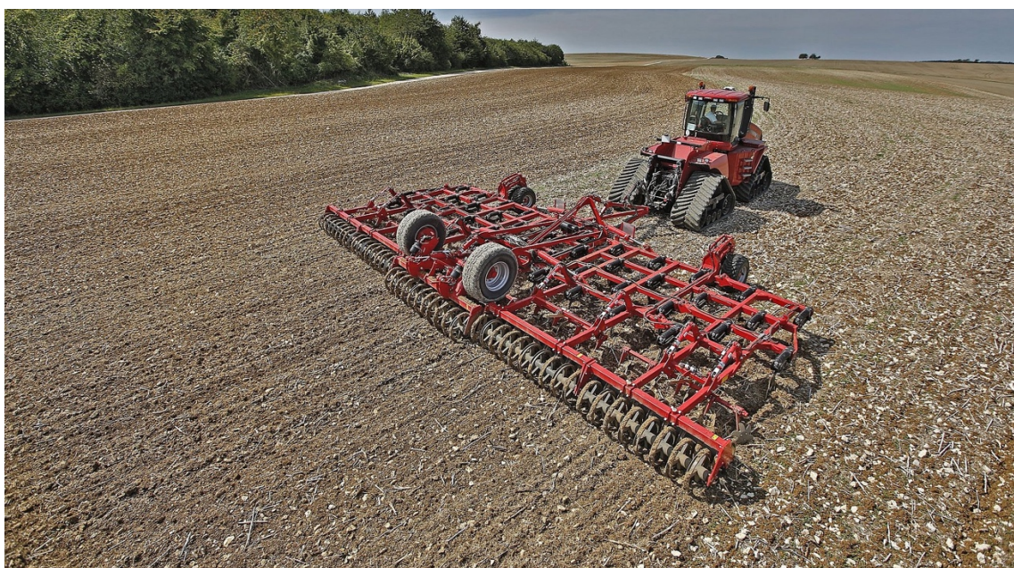
Obrázek 1: Souprava traktoru CASE IH Quadtrac s kypřičem Horsch Terrano FM (Zdroj: Horsch.com)
