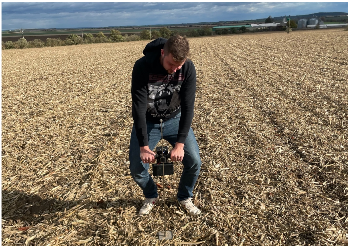
Obrázek 6: Proces měření pomocí penetrometru, zatlačování kužele do půdy (foto autor)
