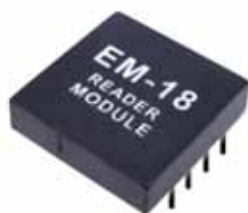
Obr. 12. RFID modul EM-18 [11]
