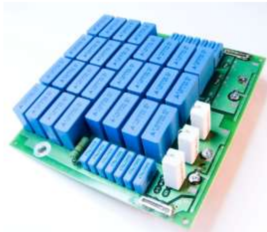
Obr. 31: Fotografie desky primárních obvodů zapojené podle Obr. 30 (fotografováno před dokončením, některé součástky proto na snímku chybí)
