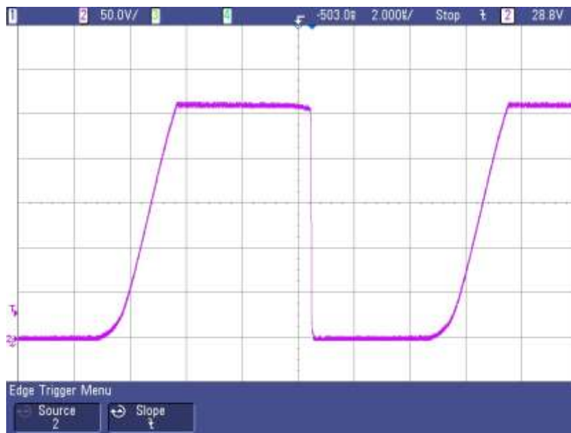
Obr. 60: Průběh napětí u_{CE} dolního tranzistoru při chodu naprázdno při napětí polovičního meziobvodu 250 V
