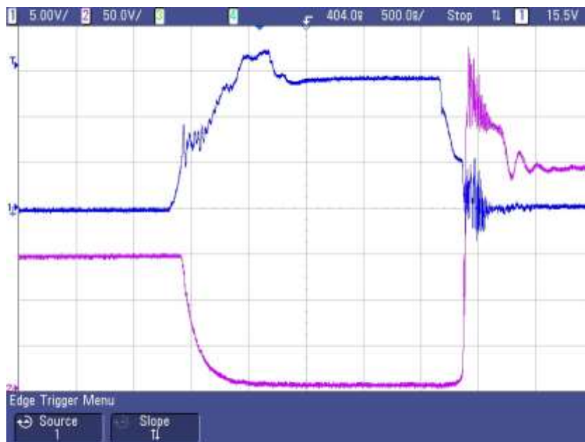
Obr. 58: Průběh řídicího napětí u_{GE} a napětí u_{CE} dolního tranzistoru při napětí polovičního meziobvodu 250 V a celkovém výstupním proudu měniče 100 A
