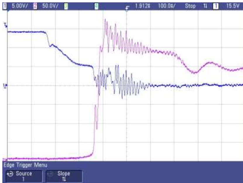
Obr. 59: Detail procesu vypnutí z Obr. 58
