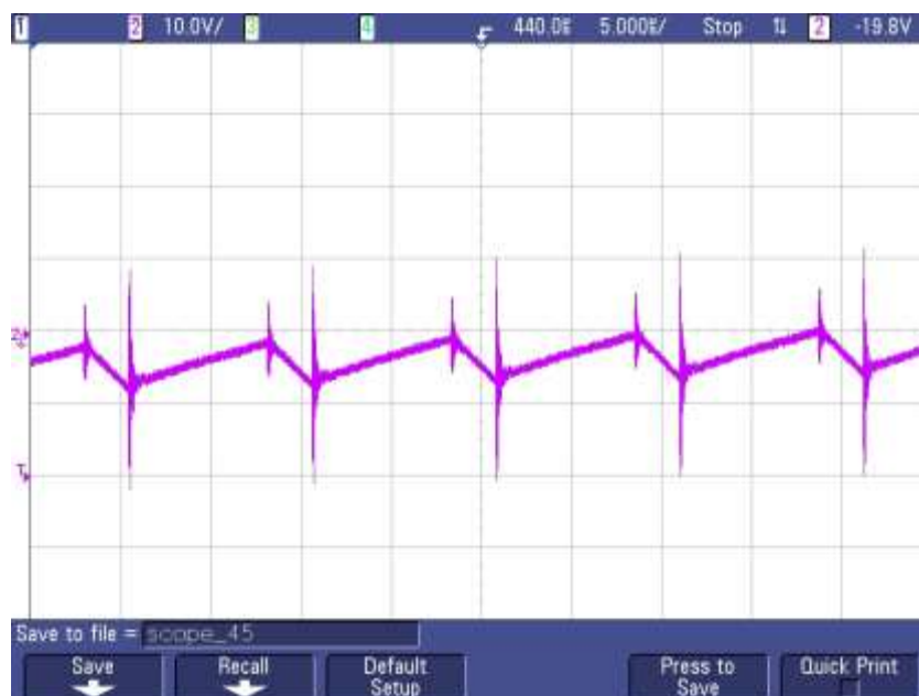
Obr. 54: Detail průběhu vf zvlnění napětí na polovičním meziobvodu
