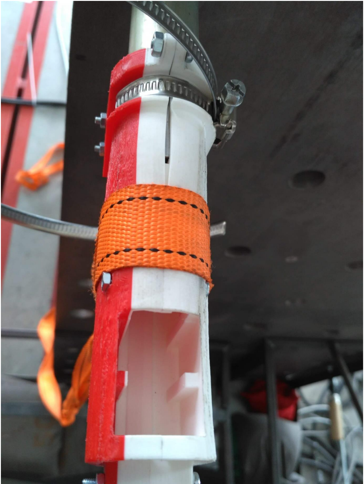
Foto 5: Zkouška nástavce ŘP, rozevírání součástí při početním zatížení na přední straně
