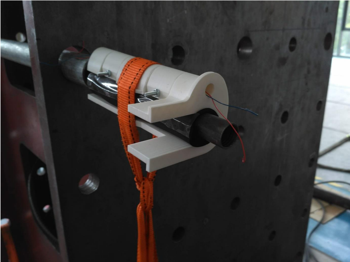
Foto 8: Zkouška nástavce pedálu, početní zatížení, detail
