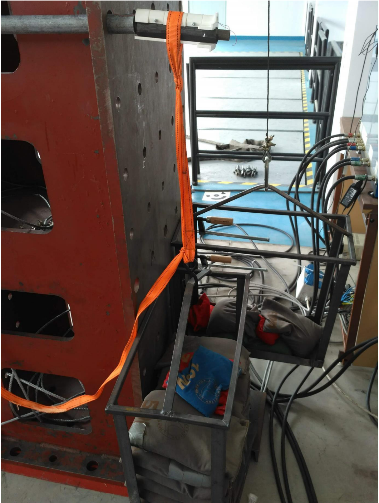
Foto 7: Zkouška nástavce pedálu, početní zatížení
