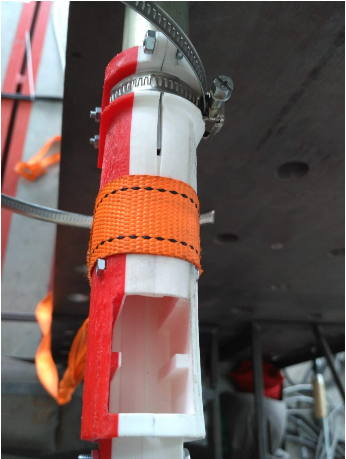
Foto 5: Zkouška nástavce ŘP, rozevirání součástí při početním zatížení na přední straně
