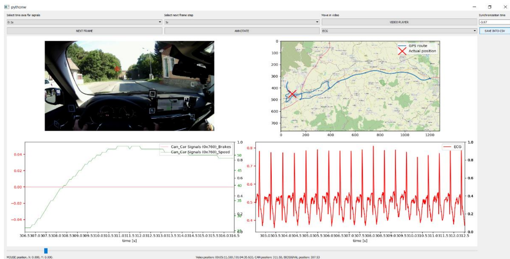
Obrázok 7. 4 : Príklad spusteného programu pre konkrétne dáta so zobrazeným statickým obrazom z kamery, aktuálnou polohou na mape, signálmi z pedálov a biosignálov so synchronizáciou.
