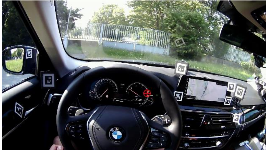
Obrázok 7. 2 : Pohľad na interiér vozidla z implementovanej kamery v okuliaroch vodiča. Značky s "QR kódmi". Červený terč.
