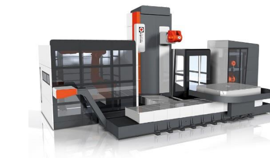
Obrázek 25 – stroj typu FUT: posuvný stůl, posuvný stojan (dopředu a dozadu), možnost pevného a výsuvného vřeteníku, variabilita výměnných hlav
