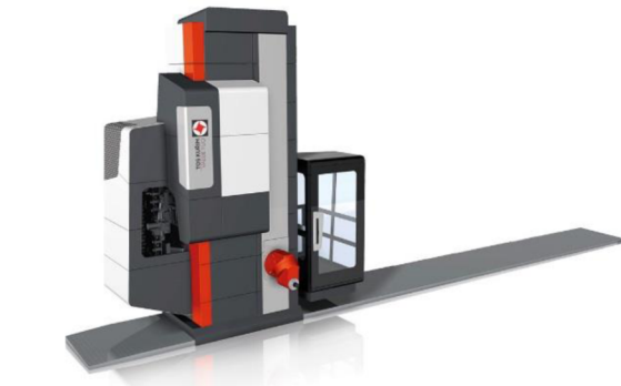
Obrázek 26 – stroj typu FU: posuvný stojan, variabilita pracovního prostoru a výměnných hlav, výsuvný vřeteník
