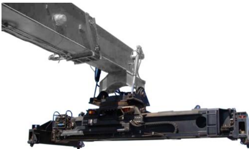
Obr. 7.10 Posuvný a naklápěcí závěsný rám [33]
