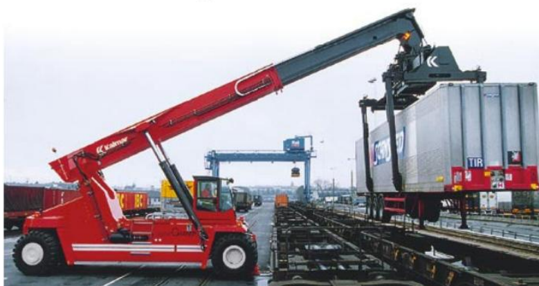
Obr. 8.9 Výsuvný stohovač se závěsným rámem s kleštinami [28]
