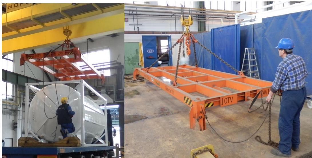
Obr. 7.2 Mechanické ovládání závěsného rámu [32]
