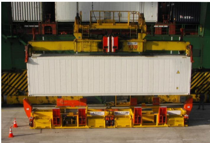
Obr. 8.4 Automatický stůl na nasazování otočných zámků k fixaci [33]
