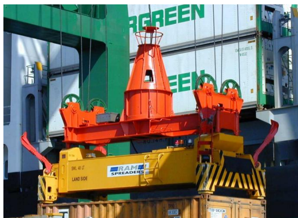
Obr. 6.3 Připojení závěsného rámu otočnými zámky [33]
