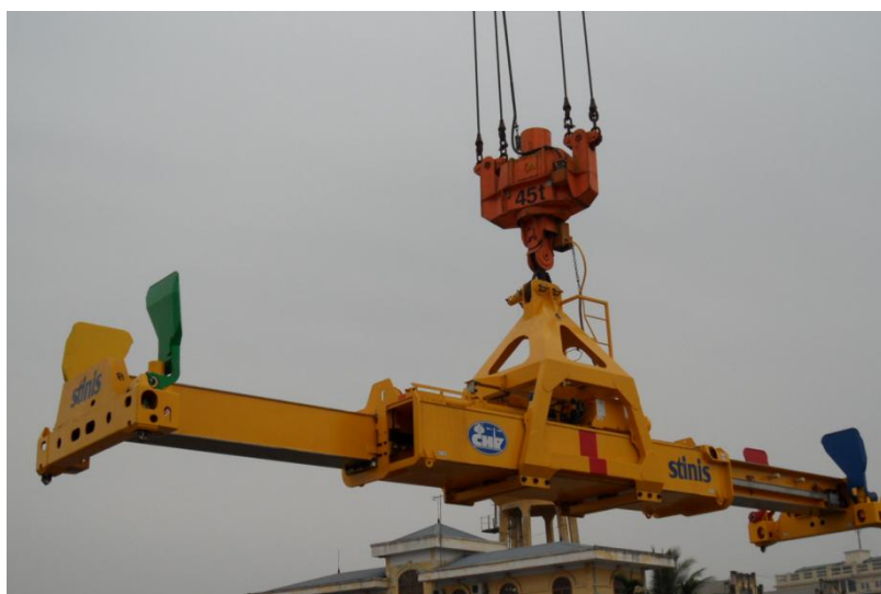
Obr. 6.4 Spojení závěsného rámu na hák jeřábu [35]
