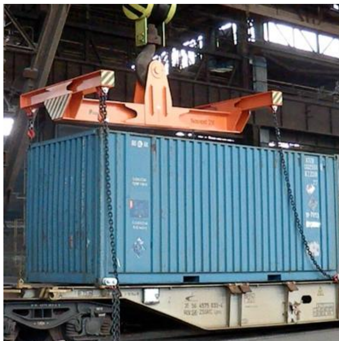
Obr. 7.20 Traverza s lanovými závěsy [31]
