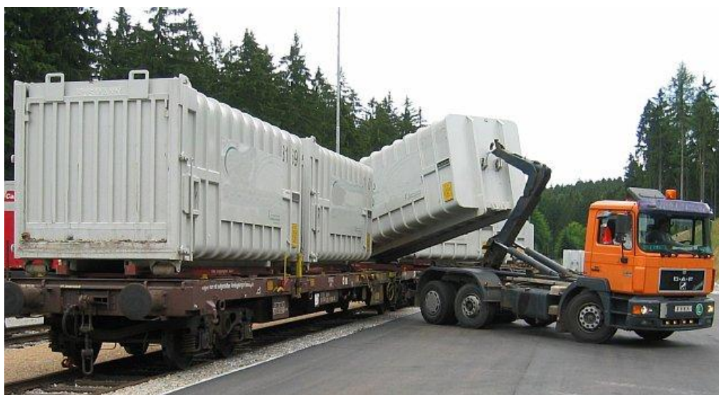
Obr. 2.2 Překládka odvalovacích kontejnerů [19]
