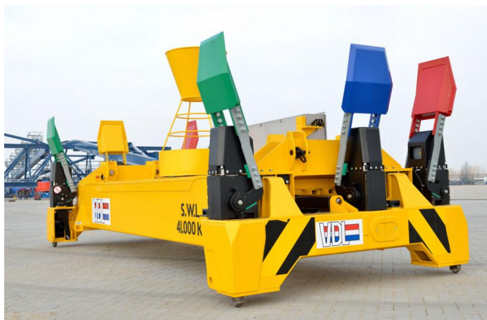
Obr. 7.8 Závěsný rám se sklopnými naváděcími lištami [39]
