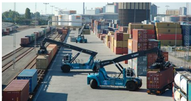
Obr. 5.7 Překládání kontejnerů mobilními překladači [29]
