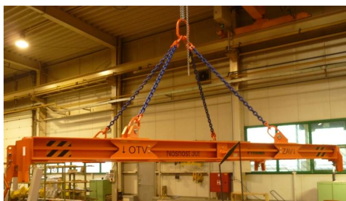
Obr. 6.5 Spojení jeřábu a závěsného rámu řetězy [32]
