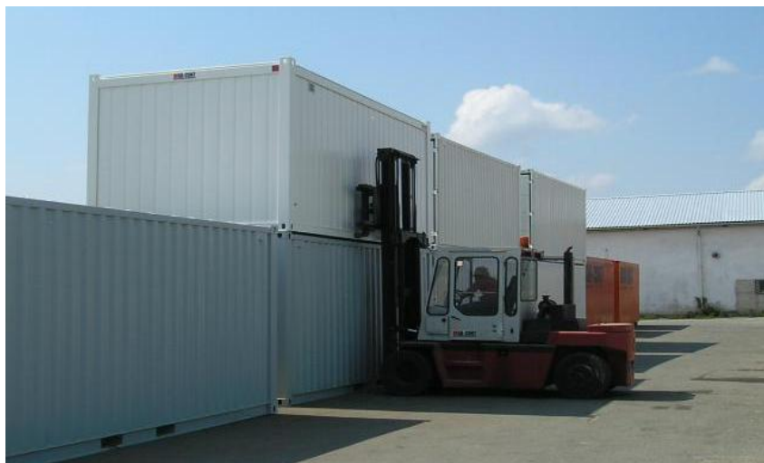
Obr. 7.18 Manipulace kontejnerů vidlicemi [21]
