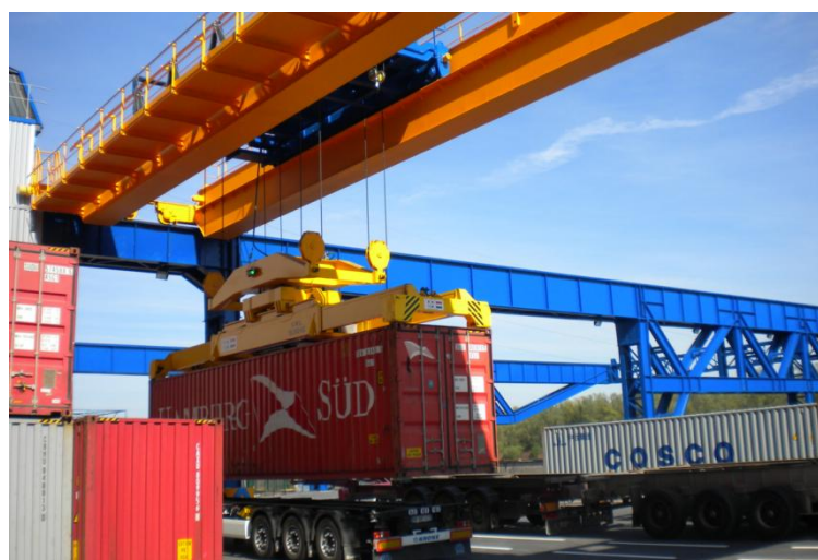
Obr. 8.7 Horní přestavitelný single lift závěsný rám [39]
