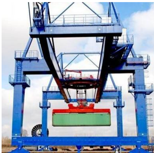
Obr. 8.6 Portálový jeřáb s horním přestavitelným závěsným rámem [22]
