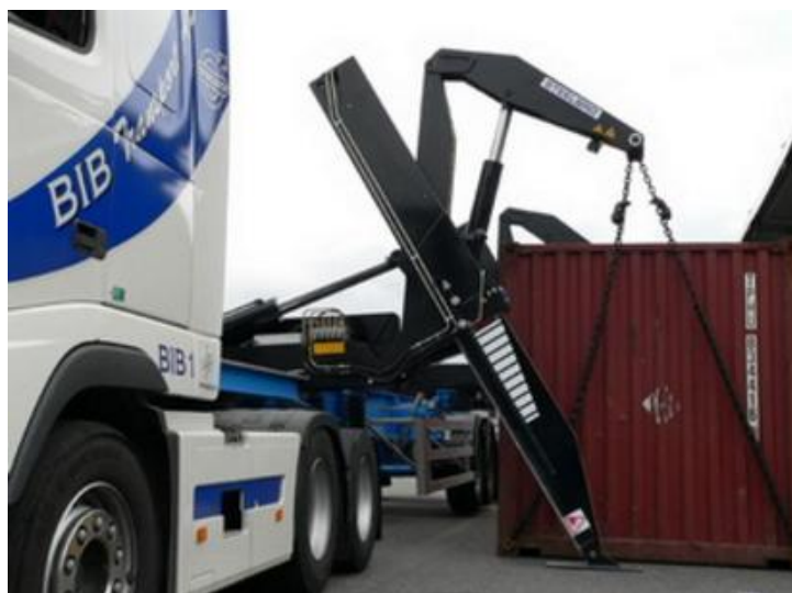
Obr. 6.8 Připojení lanových závěsů [24]
