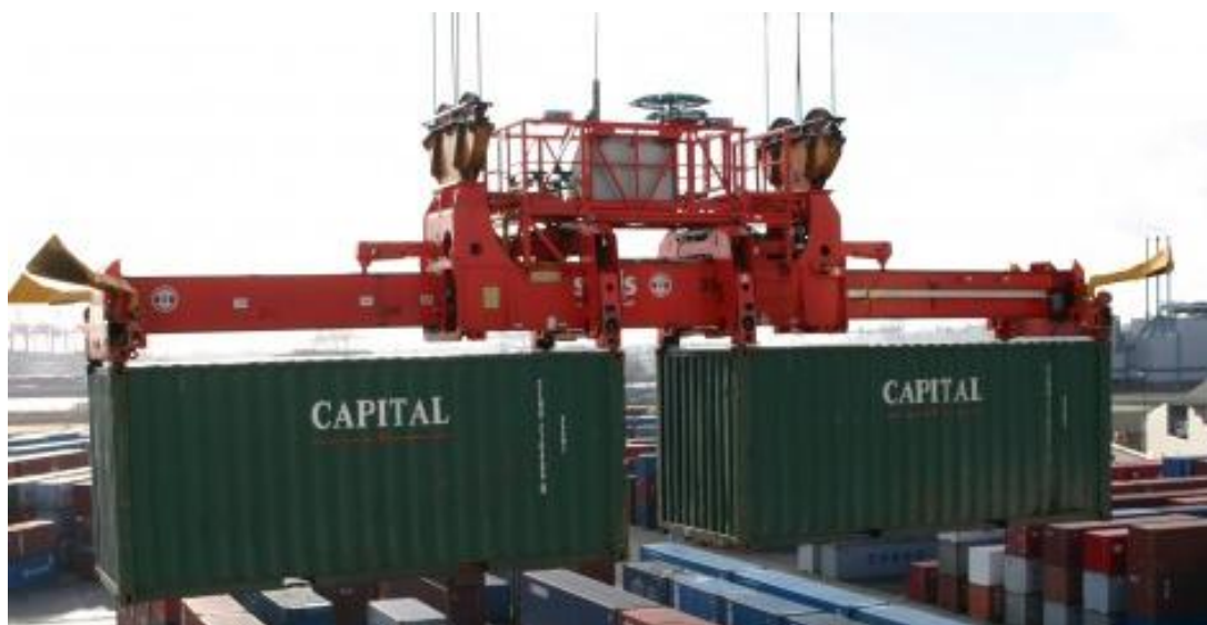
Obr. 7.3 Přestavitelný závěsný rám se systémem twin lift [35]
