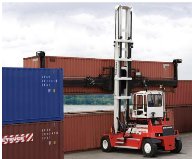
Obr. 8.5 Boční závěsný rám s čelním kontejnerovým vozem [36]
