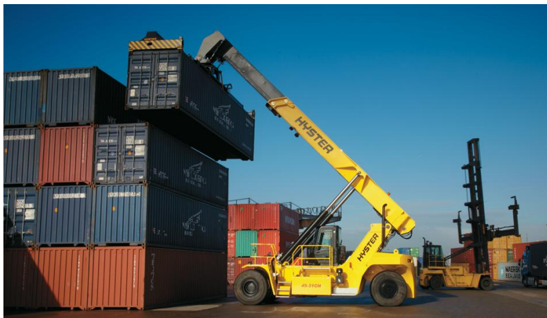
Obr. 8.8 Výsuvný stohovač s horním závěsným rámem [27]
