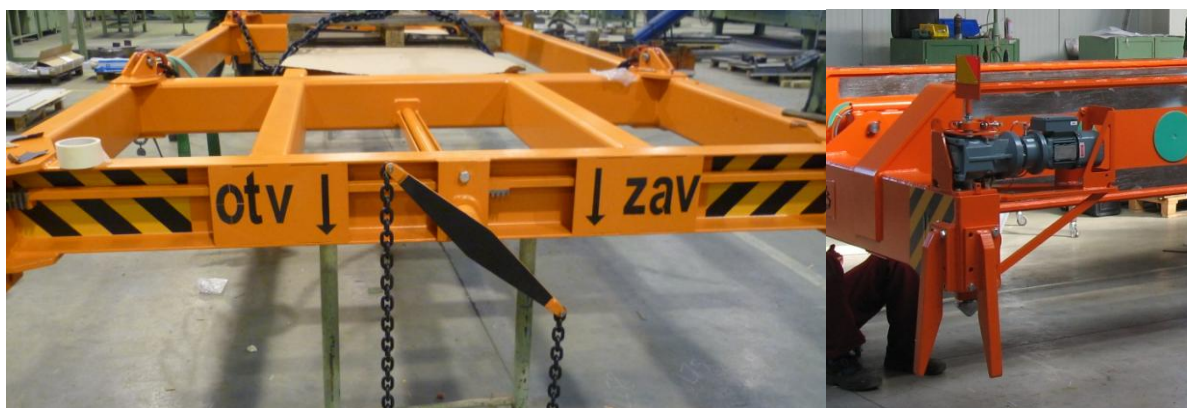
Obr. 7.6 Ovládní otočných zámků: a) ruční, b) elektrické [32]
