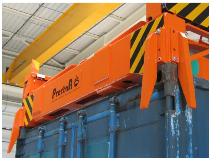
Obr. 4.1 Navádění a fixace za rohové prvky kontejneru závěsným rámem [32]
