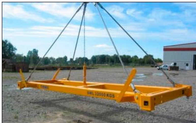
Obr. 7.5 Závěsný rám se s ovládním otočných zámků gravitací a zdvihem [38]
