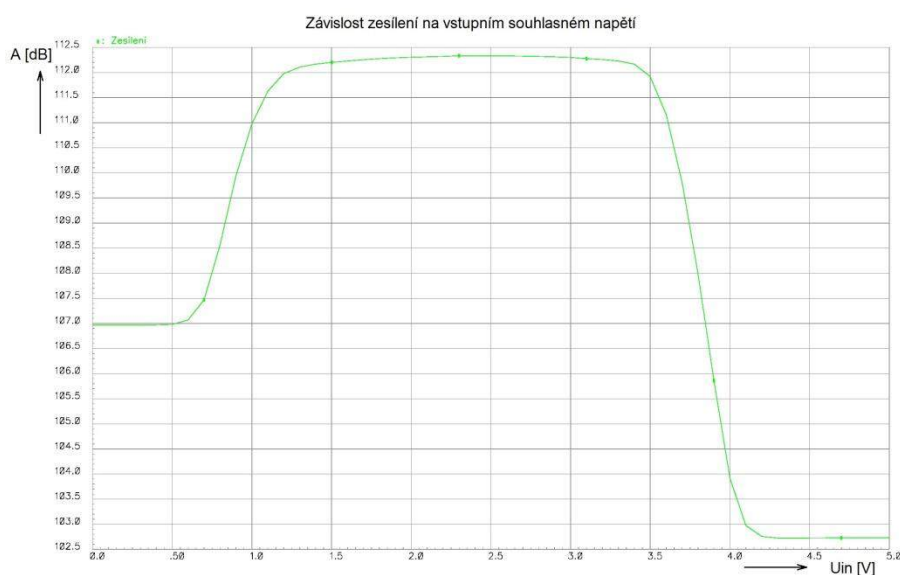
Obr. 28 Závislost zesílení na vstupním souhlasném napětí, bez kompenzace
