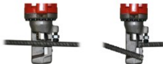
Obr. 23 Stříhání tyče otevřenými noži [1]
