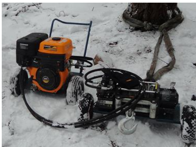
Obrázek 9: Pohonná jednotka s navijákem Golemwinch; autor: Martin Gregor
