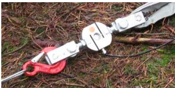
Obrázek 10: Připojený tenzometr; autor: Václav Štícha
