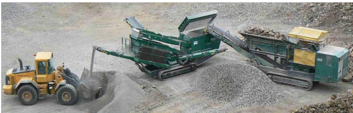
Obr. 24 Drticí a třídící jednotka kameniva. [23]
