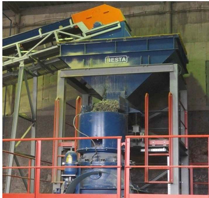
Obr. 25 Část linky na drcení a mletí kameniva. [23]
