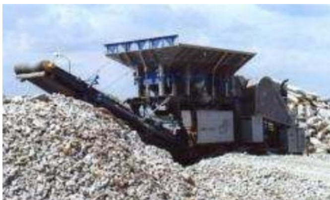
Obr. 13 Drtící linka na stavební odpad. [16]
