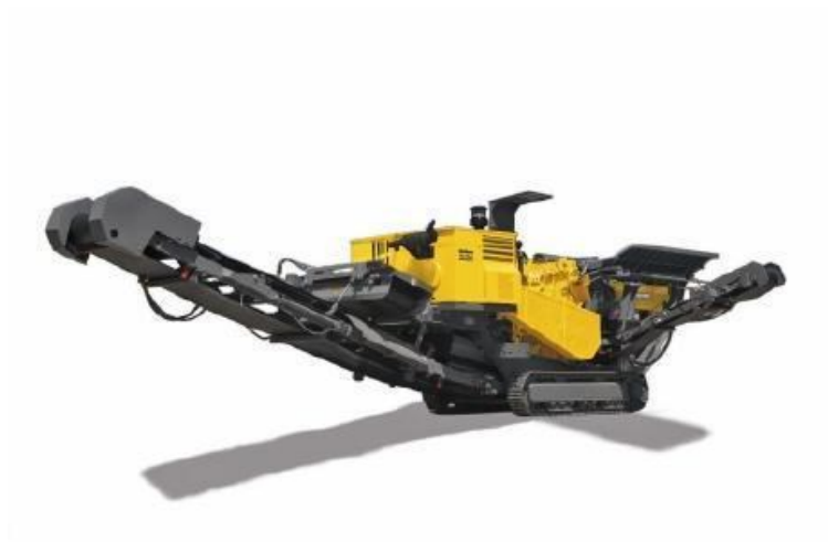
Obr. 26 Drtící a třídící jednotka Atlas Copco PC 1060. [24]
