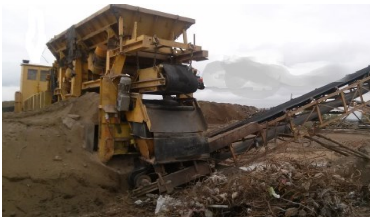
Obr. 23 Odrazový drtič s magnetickým odlučovačem. [20]
