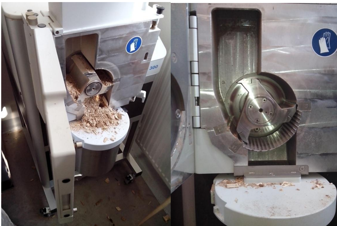
Obr. 19 - Laboratorní mlýn při výrobě středových třísek vlevo a pro povrchové třísky s vloženým sítím vpravo
