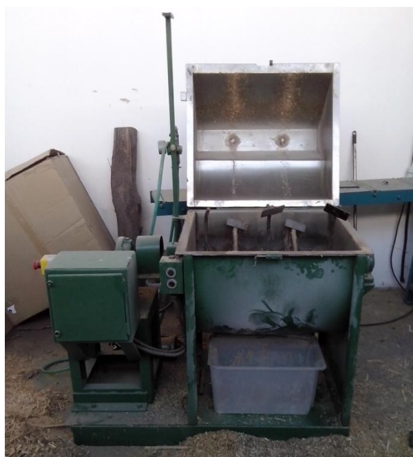
Obr. 24 – Lopatkový míchačí stroj s lopatkami
