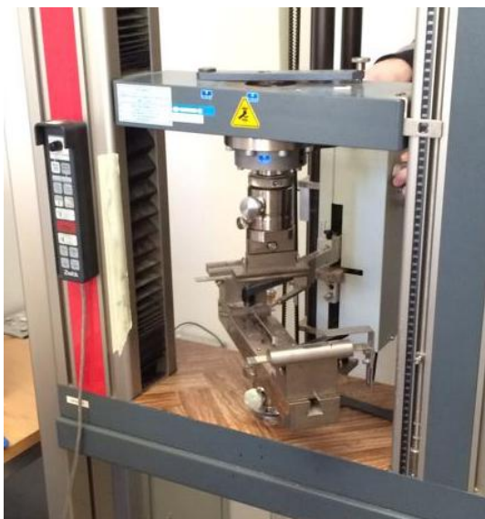
Obr. 32 - Stroj ZWICK Z050 pro testování ohybu
