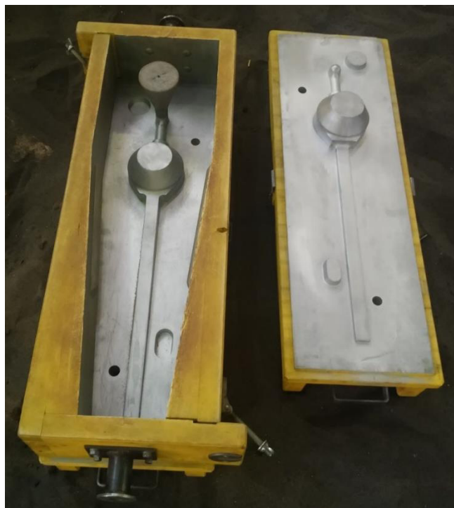
Obr. 6.2 Modelové zařízení pro Lukešovu zkoušku.
