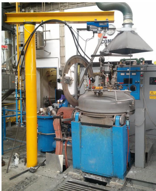
Obr. 6.4 Indukční vakuová pec CONSARC.
