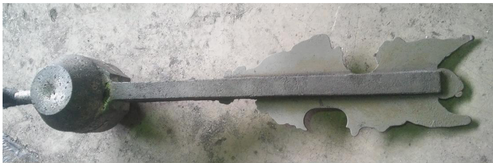
Obr. 6.8 Zateklina v dělicí rovině (TK4).
