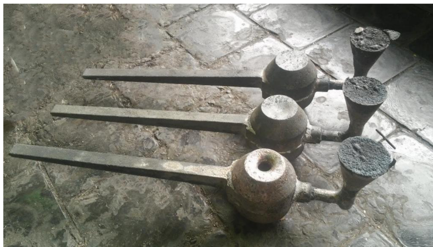
Obr. 6.7 Odlitky Lukešovy zkoušky (1. tavba).
