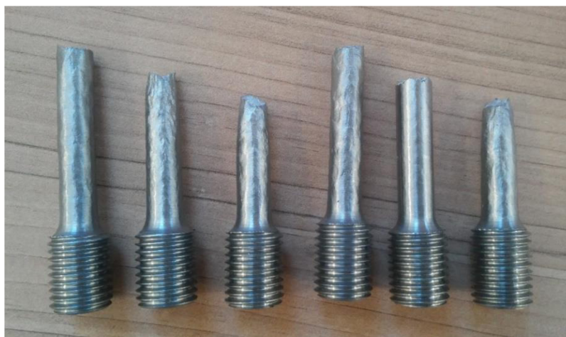
Obr. 6.23 Přetrhané vzorky tahové zkoušky, zleva vzorek z tavby 3, 4, 5, 6, 7, 8.
