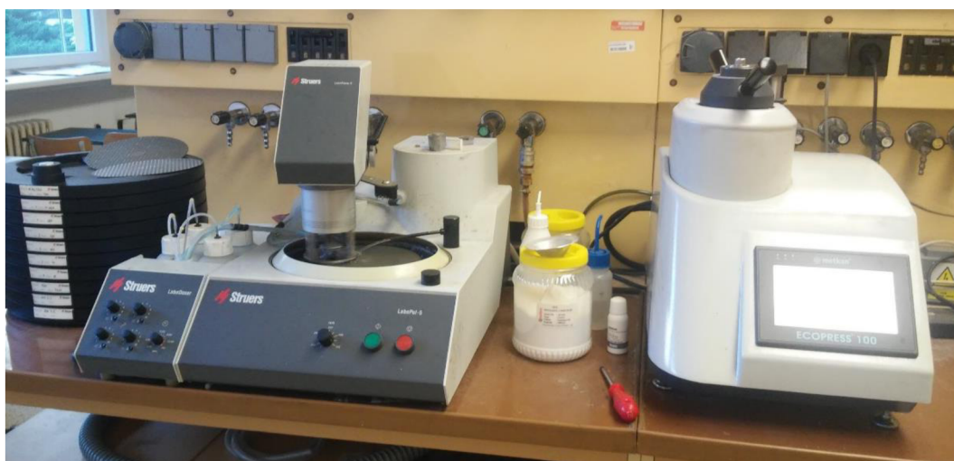
Obr. 6.36 Přístroje použité na výrobu metalografického výbrusu (vpravo přístroj na lisování, vlevo leštící přístroj).
