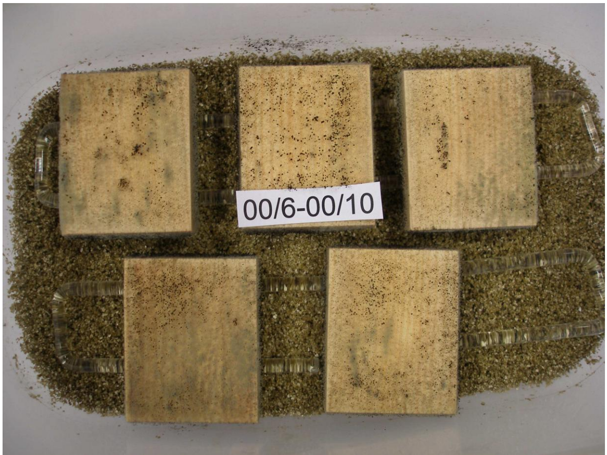
Obr. 30 Neošetřená zkušební tělesa – kontrola virulence
