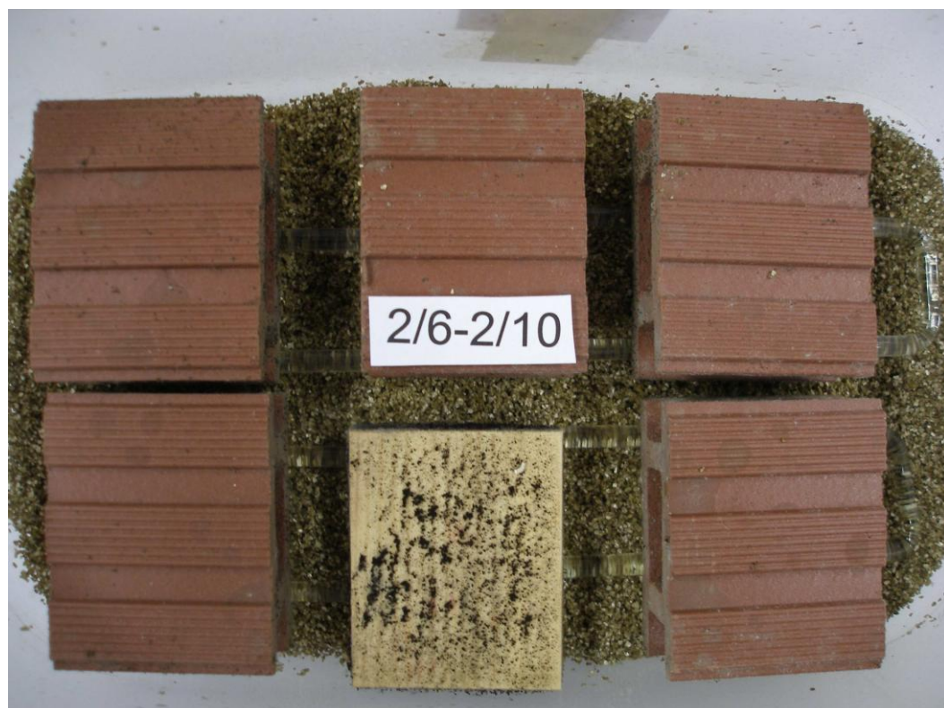
Obr. 27 Zkušební tělesa zhotovená z dřevoplastové desky Grenadeck ošetřená Algon Paste
