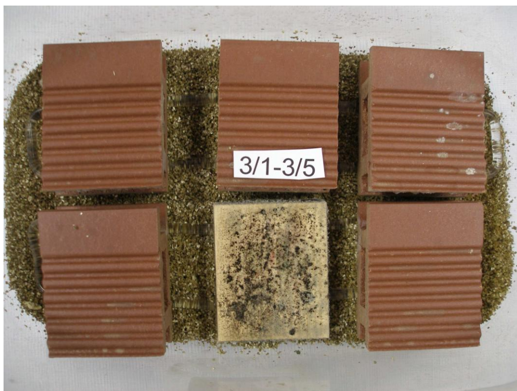
Obr. 28 Zkušební tělesa zhotovená z dřevoplastové desky Grenadeck ošetřená 1,2 % koncentrací Zink Boratu.
