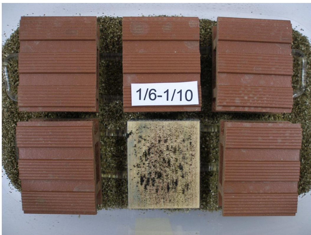
Obr. 26 Zkušební tělesa zhotovená z dřevoplastové desky Grenadeck ošetřená 0,1% koncentrací Preventolu MP 11
