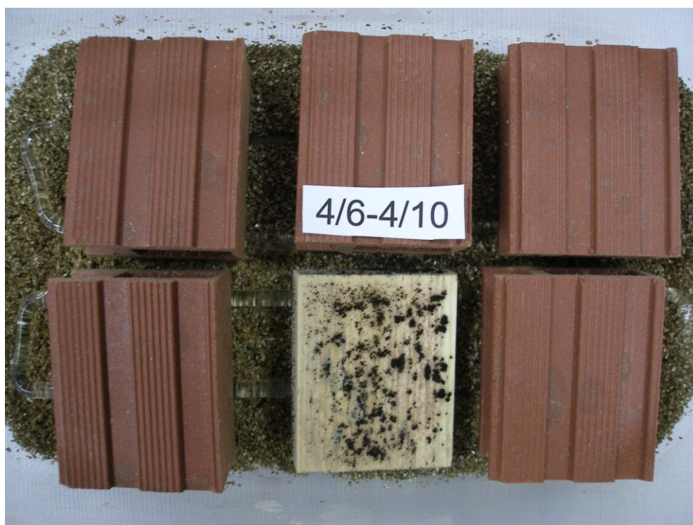
Obr. 29 Zkušební tělesa zhotovená z dřevoplastové desky Grenadeck ošetřená 0,2 % koncentrací Preventolu MP 11
