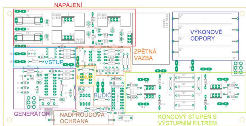
Obr. 4-4 Rozdělení bloků na DPS
