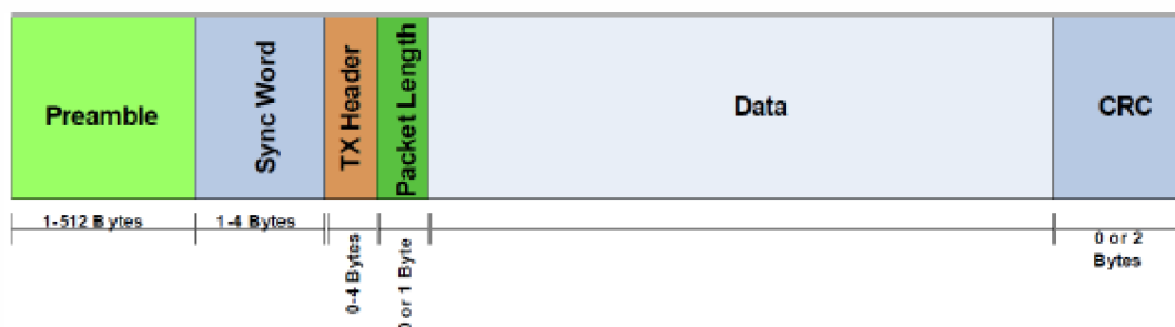
Obrázek 3- Struktura paketu RF modulu [5]
