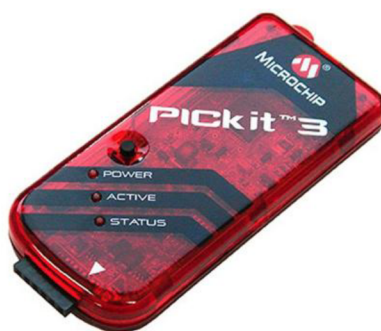
Obrázek 13-Programovací a ladící nástroj PICKIT3 [18]
