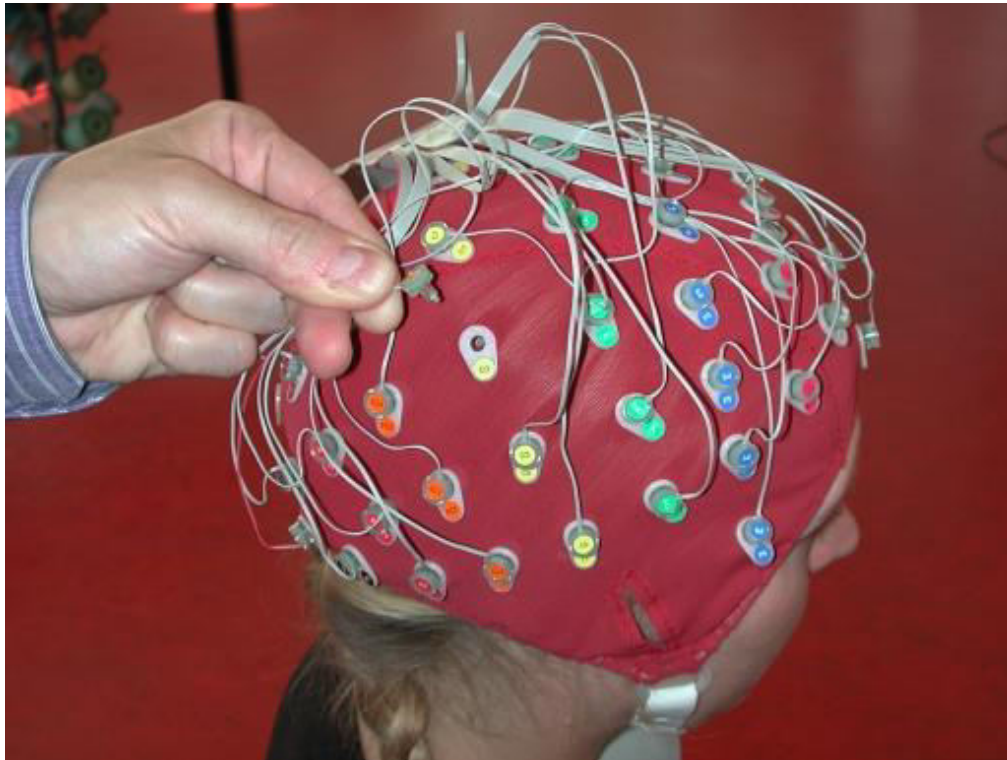
Obrázek č.6: Zapojení elektrod systému EEG typu BIOSEMI. Převzato z http://www.biosemi.com/pics/apply_cap3_large.jpg
