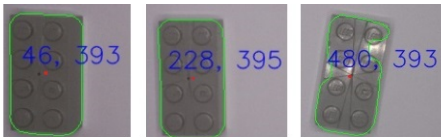
Obr. 22: Odchylka na okraji obrazu, bez deformací, deformace odleskem
