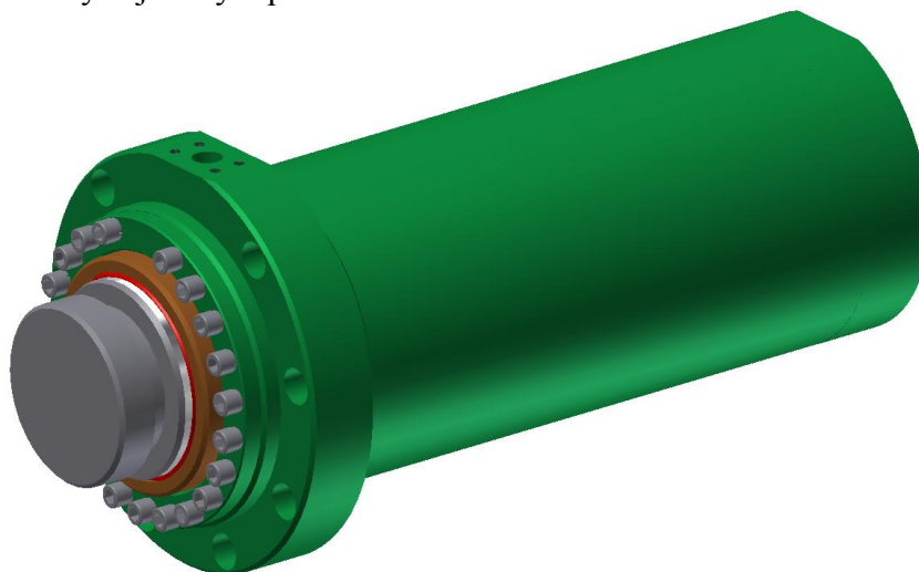
Obr. 1.6 Hydraulický válec beranu.
