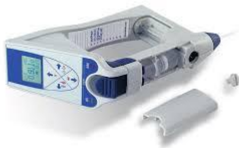
Obrázek 18: Hustoměr Densito 30 PX ( www.swma.org )
