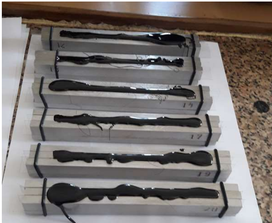
Obrázek 34: Asfaltové pojivo ve formě pro měření BBR
