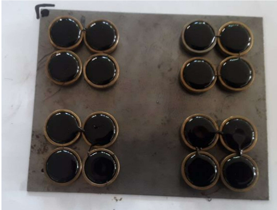
Obrázek 21: Kroužky se zahřátým pojivem na odlévací destičce
