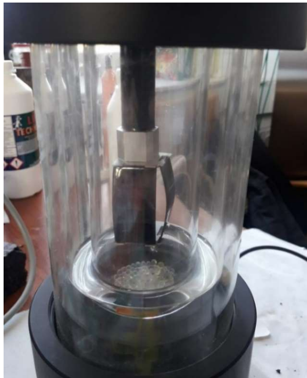
Obrázek 28: Přístroj pro stanovení bodu lámavost podle Fraasse
