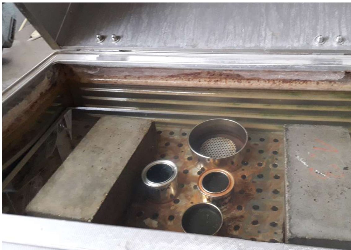
Obrázek 19: Temperování zkušebních kelímků s pojivem
