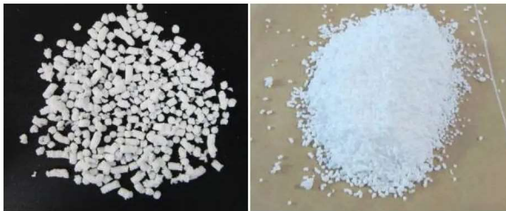
Obrázek 13: SBS jako granule nebo vlákna [34]
