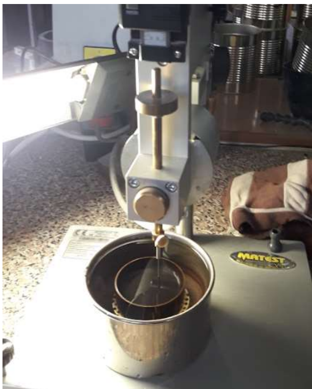
Obrázek 20: Měření penetrace jehlou
