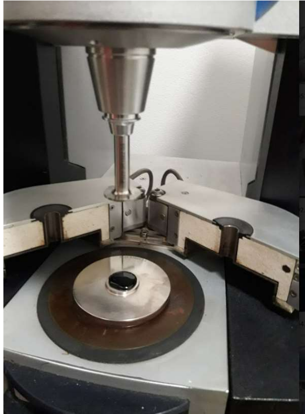
Obrázek 23: Umístění vzorku do reometru
