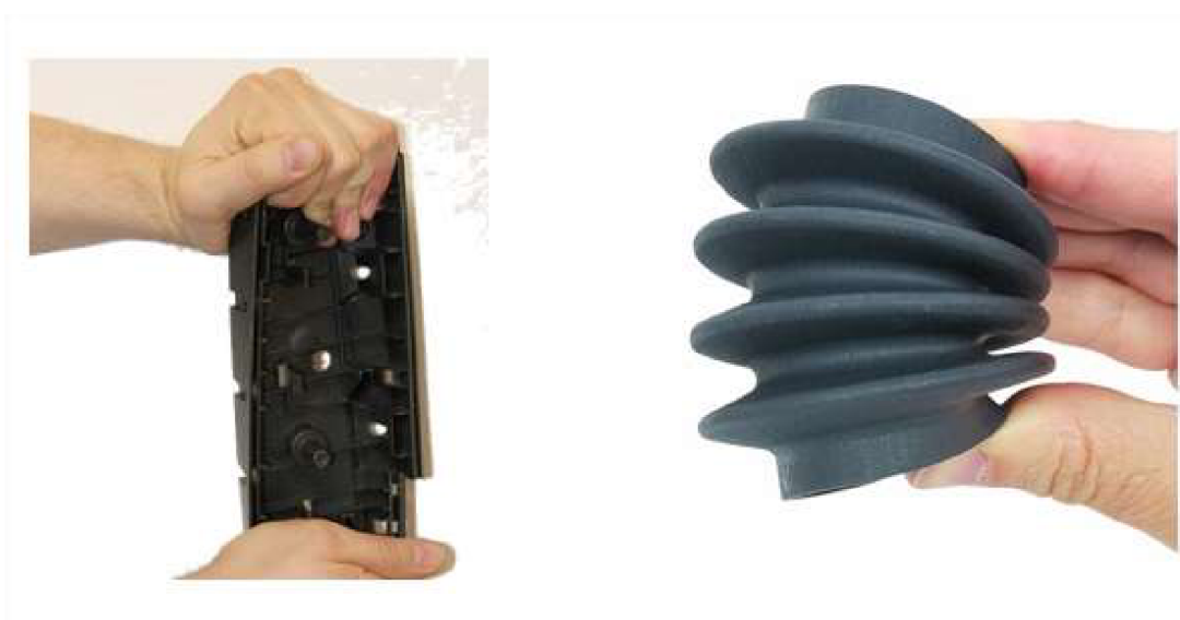
Obrázek 10: Chování polymerů při mechanickém namáhání: plast (vlevo), elastomer (vpravo) [14]
