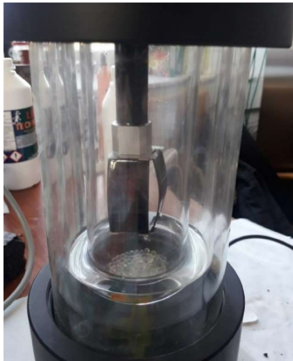
Obrázek 28: Přístroj pro stanovení bodu lámavost podle Fraasse
