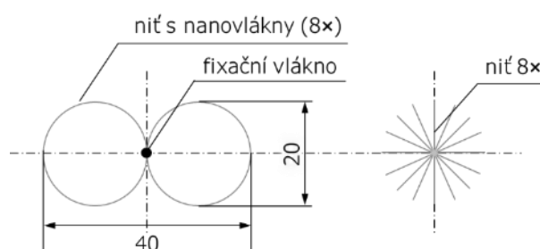
Obrázek 12: Technický výkres cirkulárního nanovláknenného nosiče použitého pro testování vyvíjené sterilizační metody (dimenze v mm)
