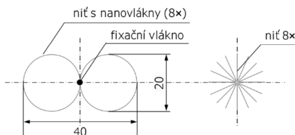
Obrázek 12: Technický výkres cirkulárního nanovláknenného nosiče použitého pro testování vyvíjené sterilizační metody (dimenze v mm)
