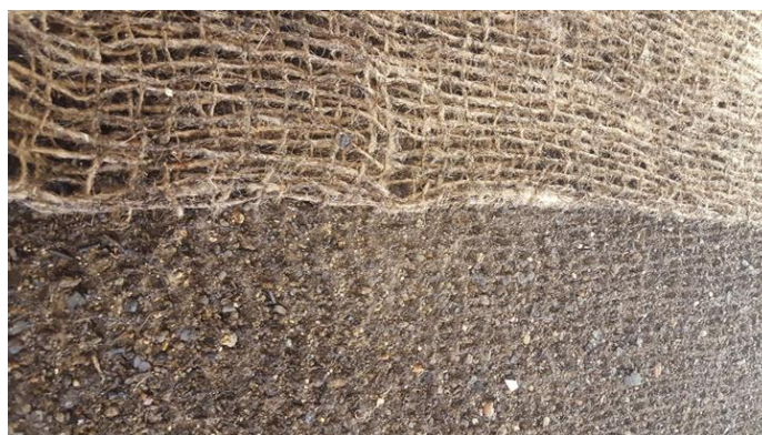
Obrázek č. 5: Plocha s jutovou geotextilií po simulaci deště
