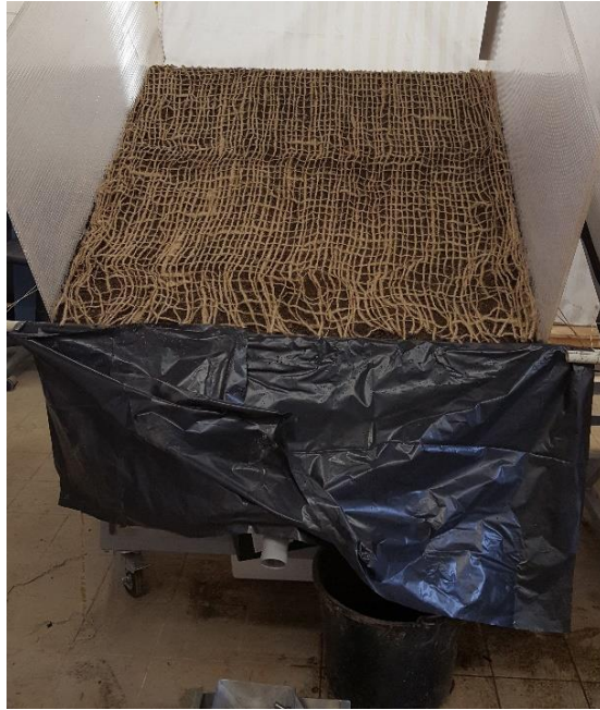
Obrázek č. 19: Odtokový žlab s jutovou sítí a zakrytím trojúhelníkové části
