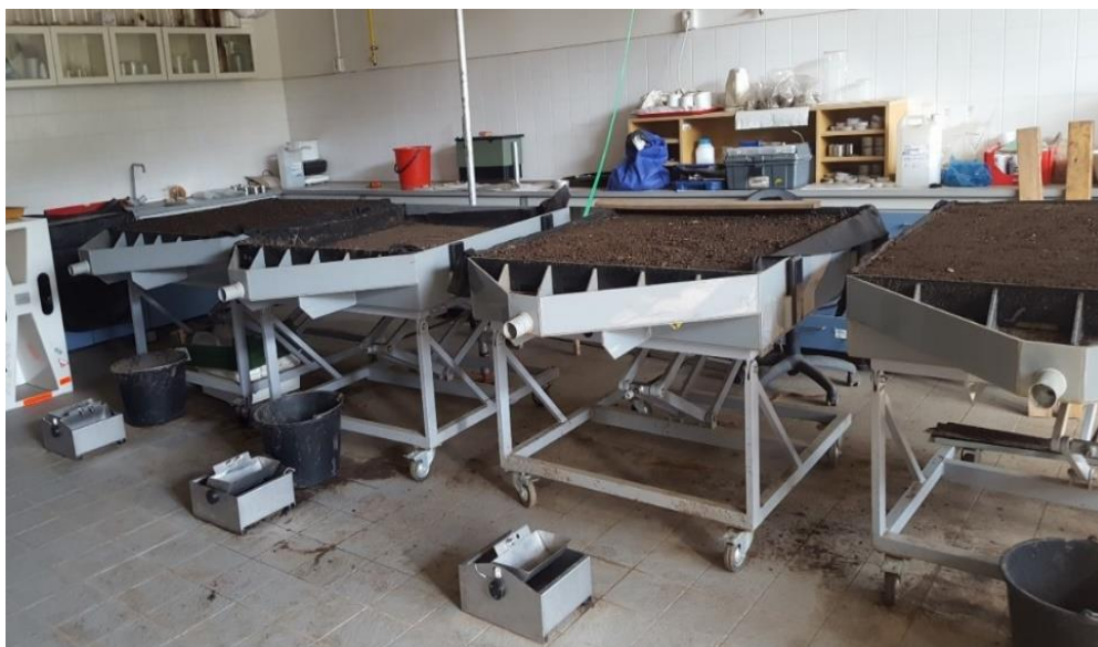
Obrázek č. 1: Příprava půdy do odtokových žlabů před zadešťovacím pokusem v erozně sedimentologické laboratoři
