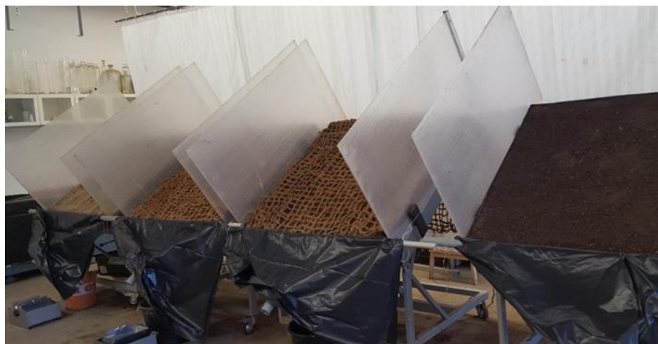
Obrázek č. 20: Připravené odtokové žlaby před zahájením simulace deště
