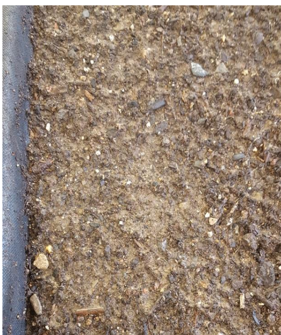
Obrázek č. 7: Kontrolní plocha po simulaci deště, kde je viditelný smyv nejjemnější frakce půdy
