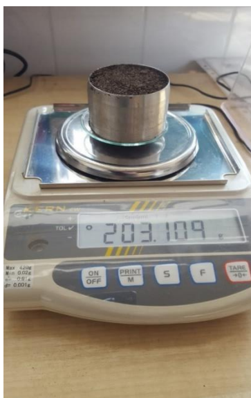
Obrázek č. 15: Vážení půdního vzorku s Kopeckého válečkem a sklíčkem
