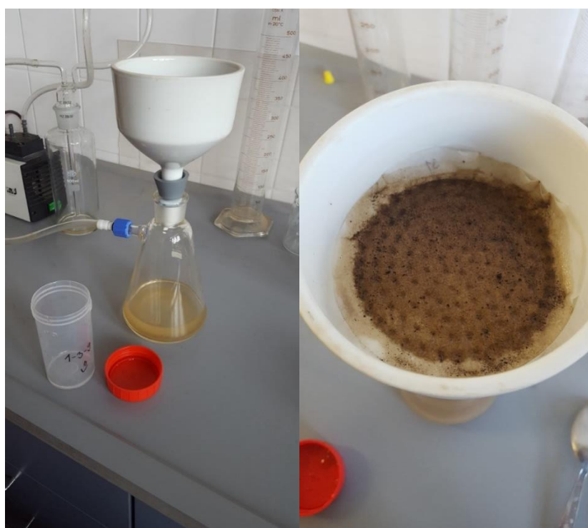
Obrázek č. 22: Podtlakové filtrační zařízení vlevo, vpravo sediment na filtračním papírku
