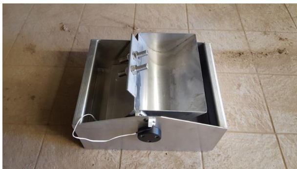
Obrázek č. 14.: Mechanický průtokoměr
