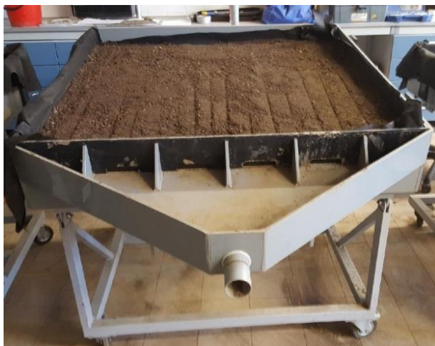
Obrázek č. 12: Postupné plnění odtokového žlabu zeminou
