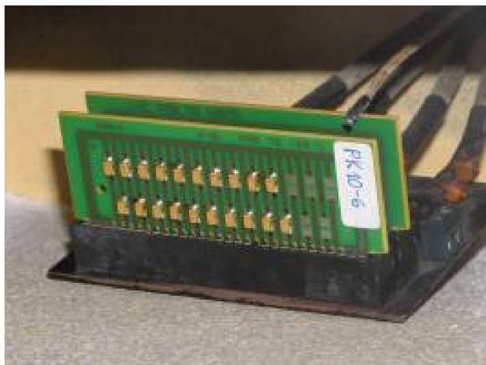
Obr. 4.1: Způsob uchycení vzorků a kontaktování na měřící pracoviště
