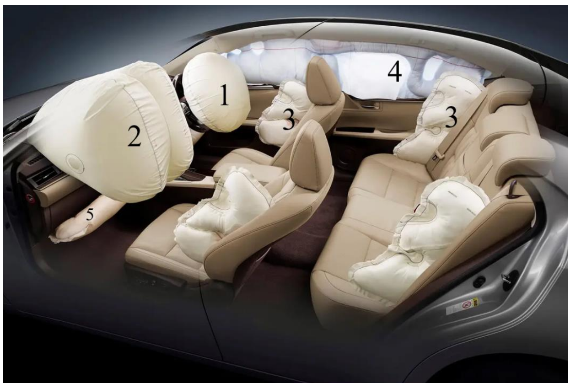
Obrázek 3 Rozmístění airbagů v automobilu (1 – čelní airbag řidiče; 2 – čelní airbag spolujezdce; 3 – boční airbag; 4 – okenní airbag; 5 – kolenní airbag) [12]
