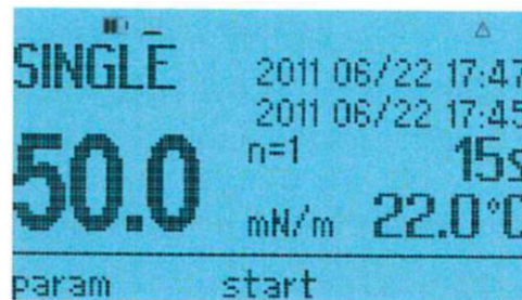
Obr. 4) Displej tenziometru SITA Pro line T15 [15]
