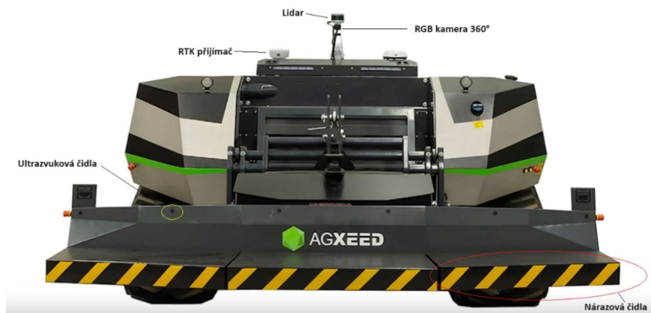
Obr. 21 Osazení senzorů polního robota AGXeed
