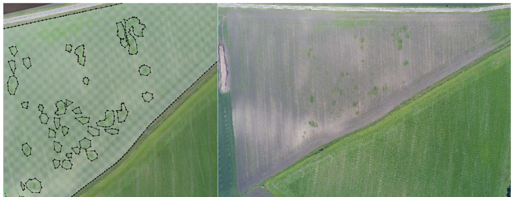
Obr. 37 Vlevo ručně vytvořená aplikační mapa dle RGB snímku vpravo, pcháč v porostu sóji
