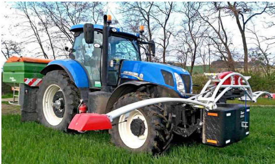
Obr. 13 N-senzor ISARIA instalovaný na traktoru při seknování porostu při aplikaci průmyslových hnojiv
