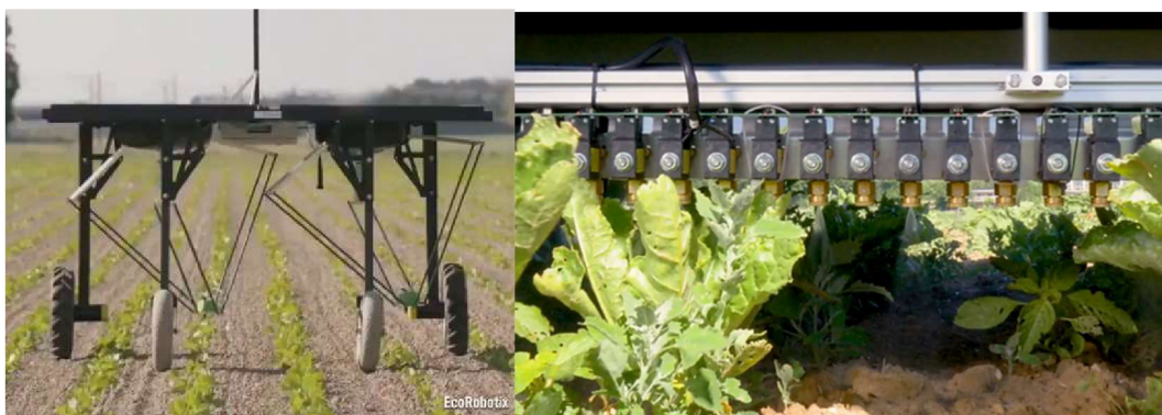
Obr. 26 Robotická ruka Ecorobotix a přesné trysky na nosiči Ecorobotix
