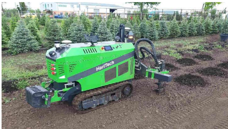
Obr. 28 Haribot robot pro vrtání děr kořenových balů
