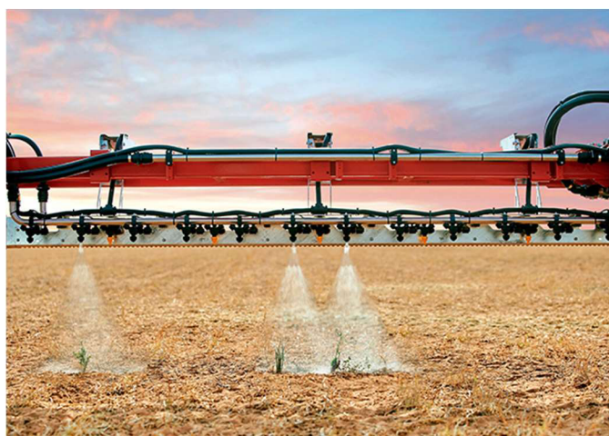
Obr. 19 Selektivní postřik pomocí optické kamery, Case IH SenseSpray
