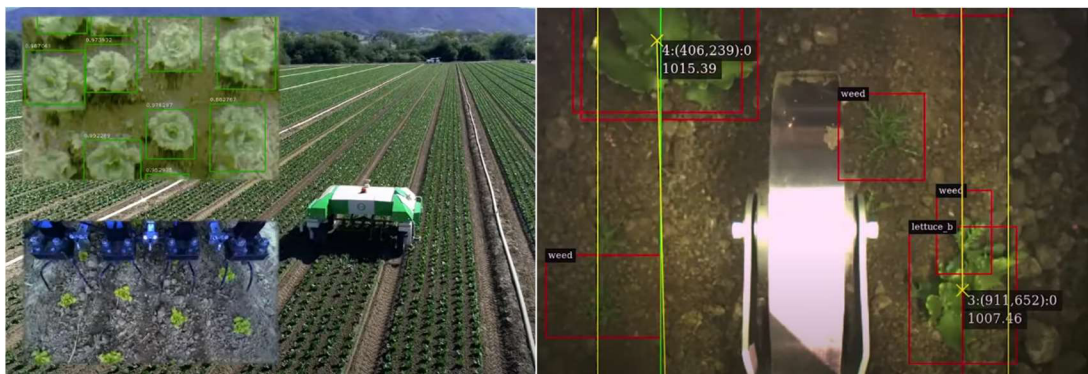
Obr. 25 Mechanická likvidace plevelu pomocí robota Dino od firmy Nairo Technologies
