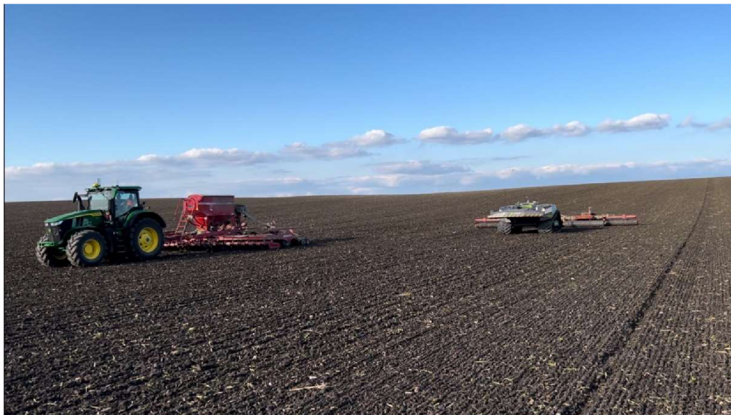
Obr. 40 AGBOT 5.115T2 v nasazení při polním provozu se secí soupravou
