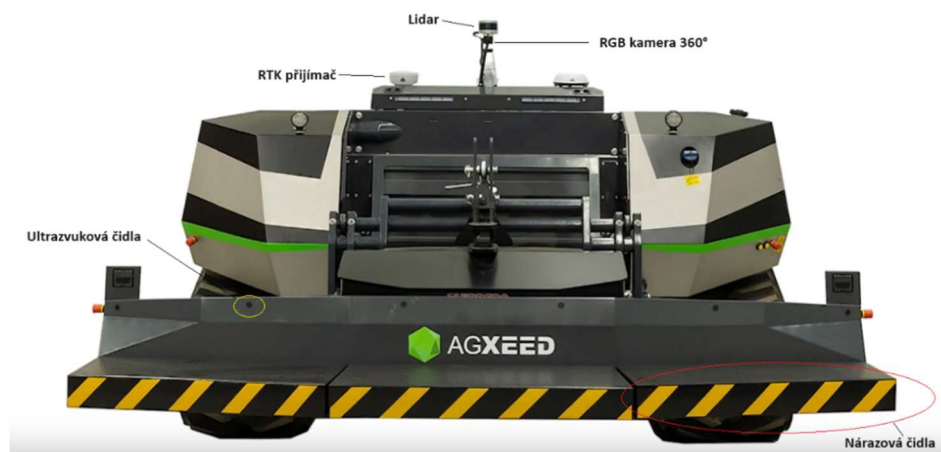
Obr. 21 Osazení senzorů polního robota AGXeed
