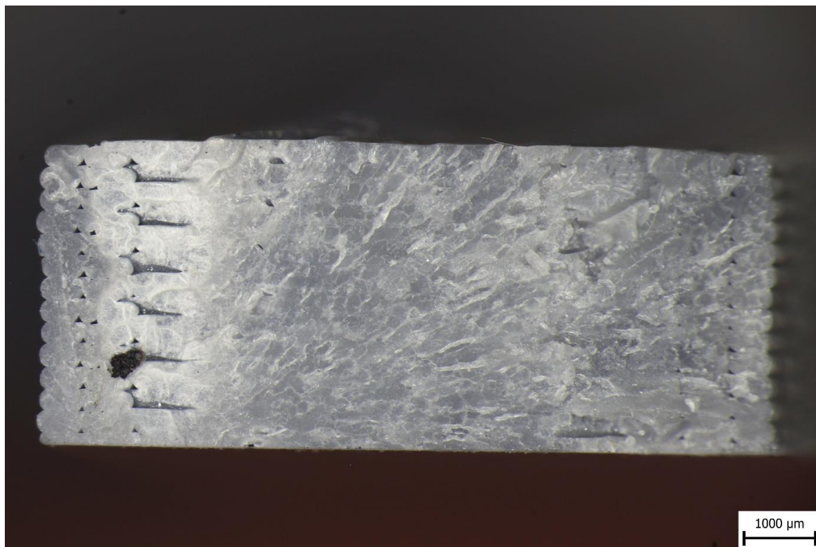
Obr. 6-7 Lomová plocha vzorku ze třetího cyklu
