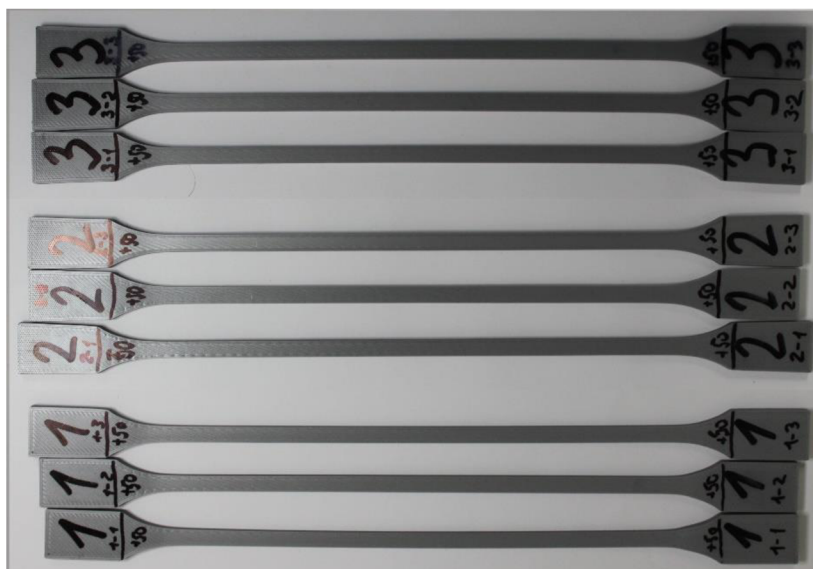
Obr. 5-5 Zkušební tělesa po provedení zkoušky tahem za zvýšené teploty
