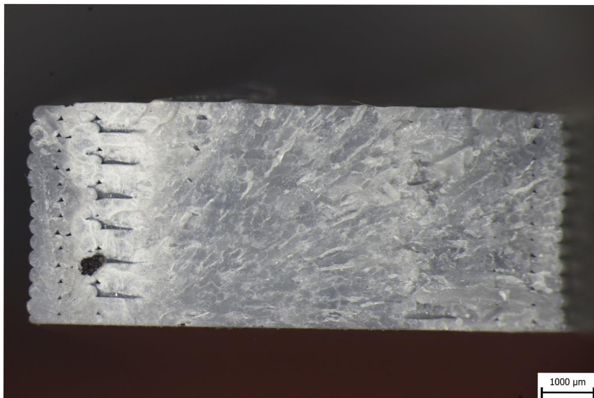
Obr. 6-7 Lomová plocha vzorku ze třetího cyklu
