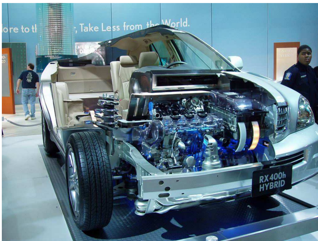
Obr.14 Ukázka mechanismu a integrace hybridního systému pohonu [11]
