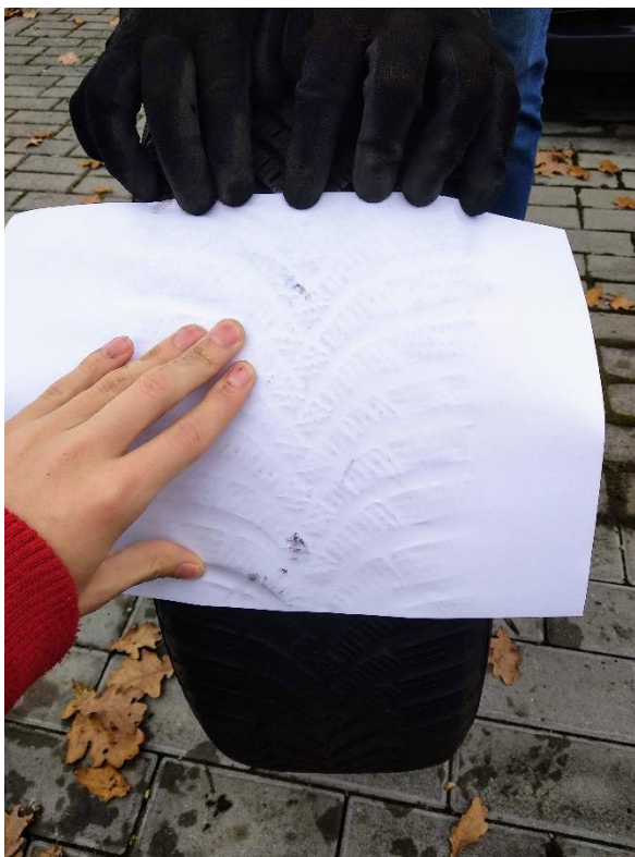
Obrázek 22 Tvorba otisku pneumatiky pomocí tempery a papíru. Zdroj: Vlastní zpracování
