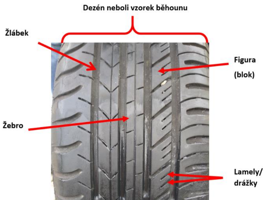
Obrázek 2 Popis běhounu pneumatiky. Zdroj: Vlastní zpracování
