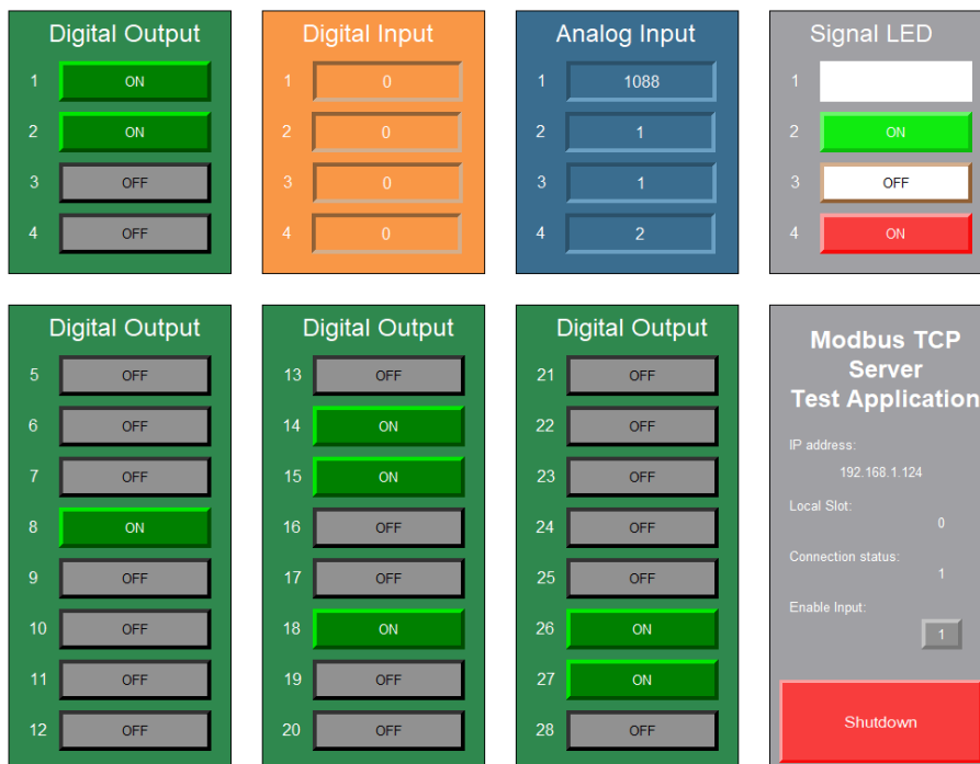
Obr. 8.7: Grafické prostredie testovacej aplikácie pri zapnutí digitálnych výstupov
