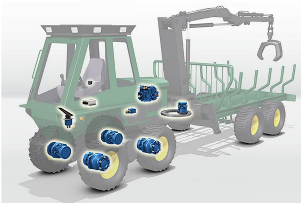
Obr. 16 Individuální pohon LVS firmy Poclain hydraulics [15]
