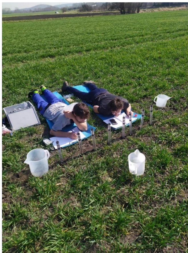
Obrázek 9 Pohled na měření nenasycených infiltrací
