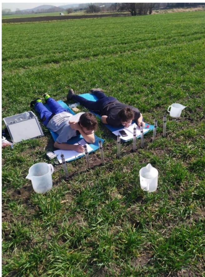
Obrázek 9 Pohled na měření nenasyčených infiltrací
