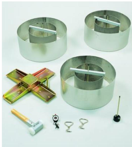
Obrázek č.6: Součásti dvouválcového infiltrometru (Ekotechnika, 2019)
