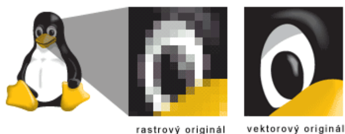
Obrázek 5: Porovnání rastrového a vektorového obrázku
